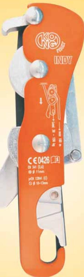
**IT** INDY è un dispositivo di discesa a comando manuale dotato di bloccaggio automatico che si attiva sia rilasciando la leva sia premendola. È conforme alla norma EN 341 classe A e viene fornito con una STATIC ROPE LANYARD Ø 11.
