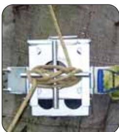
Sistema di sollevamento e frizione corde per abbattimento alberi. Consente di operare in sicurezza permettendo di controllare la calata dei rami tagliati. Deve essere usato con corde tessili o con corde con anima in metallo. Non usare cavi metallici.
